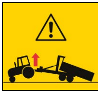
Figur 23. Advarsel – Hvis traktorens bagende løftes, har man startet en farlig bevægelse
